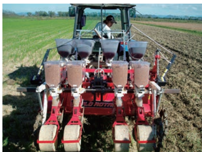
写真1 深層施肥播種機(麦用4条型)を用いた小麦の播種(2011年10月13日)
