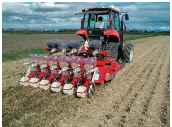
写真3 深層施肥播種機(麦用6条型)を用いた大麦の播種(2013年10月4日)
